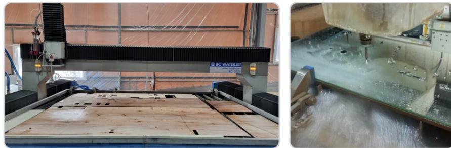
워터젯은 물의 압력을 3,500~4,000bar 이상 초고압으로 압축하여 0.75mm의 미세한 다이아몬드 노즐을 통해 음속의 속도로 원하는 가공 면적에 집중 분사시켜 절단하는 정밀 가공설비입니다. 판유리와 금속은 물론 돌이나, 자동차, 건축 내 외장재 등 다양한 산업분야에 적용되고 있으며, 원하는 모양의 따내기 가공이 가능합니다.
